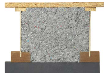
Sparrenexpander in Dämmplattenstreifen eingesteckt
