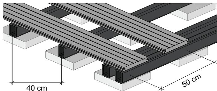
Reicht die Länge der UK-Leisten nicht aus, werden diese im Randbereich gestoßen und an jedem Auflagepunkt nach unten verschraubt. Der Stoß muss in den beiden äußeren UK-Reihen versetzt erfolgen. Die innenliegenden UK-Leisten werden zur Verlängerung auf den Fundamentplatten seitlich überlappend verlegt. Die Größe der Überlappung muss mind. eine Dielenbreite + 10 cm betragen.
