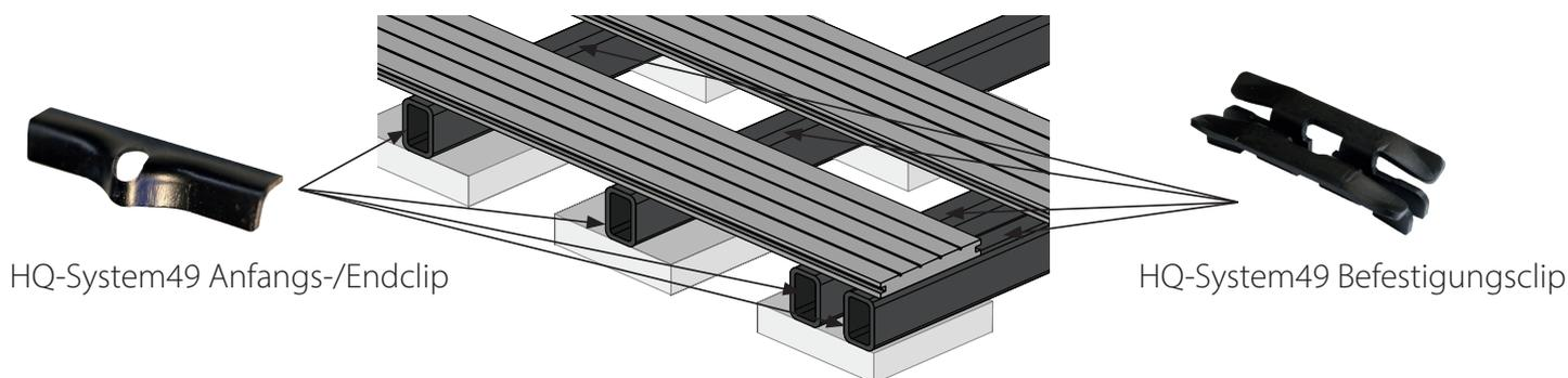
Die letzte Diele befestigen Sie wieder mit dem HQ-System49 Anfangs-/Endclip. Die Terrassendielen müssen grundsätzlich an jedem Auflagepunkt der Unterkonstruktion mittels des Clips auf beiden Seiten befestigt werden. Dabei ist darauf zu achten, dass die Terrassendielen vollflächig auf der Unterkonstruktion aufliegen.
